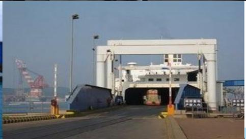
**(3)渡船。**铁路渡船是铁路车辆、货物及旅客的运载工具，铁路轮渡系统的又一关键部分。铁路渡船是一种高技术、多功能、高附加值的渡船，集客船和列车、汽车滚装船的要求于一体。
